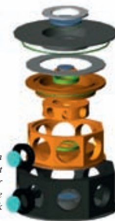
Figur 2. Samlet tegning af den elektrodynamiske fælde, der viser det dobbeltvæggede design, der tillader temperaturkontrol og otte forbindelsesporte til prøveinjektion, spredning, optisk visualisering og elektrisk gennemsløfning.
